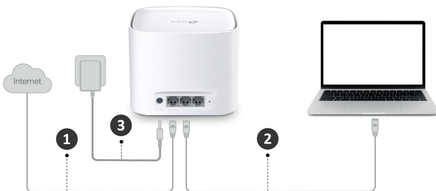
Obrázok 1 Schéma zapojenia bez optického prevodníka
