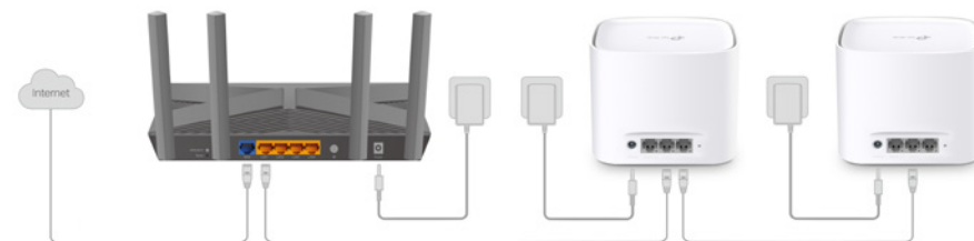
Obrázok 4 Ilustračný obrázok zapojenia v sieti EasyMesh s použitím zariadenia 2x TP-Link HX520 za sebou
